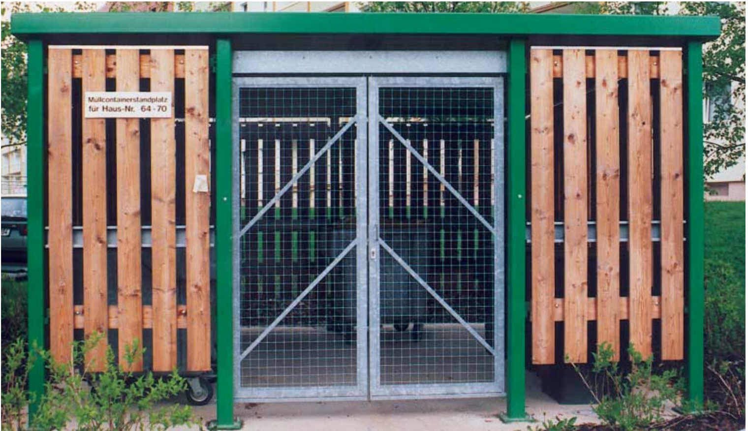
Abb.: 1 Grundeinheit für 4 Großmülltonnen à 1100 Liter, Länge 4,77 m, Tiefe 3,27 m; 2 Seitenwände, 1 Rückwand, 1 Vorderwand rechts, links, 1 Doppelflügeltür verzinkt. Alle Stahlteile feuerverzinkt und pulverbeschichtet (außer Tür) in RAL 6005 moosgrün, Wände mit Holzpaneelen beplankt, Holz imprägniert.
